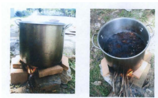
ภาพที่ 3 การต้มกาบมะพร้าวกับโซดาไฟ
