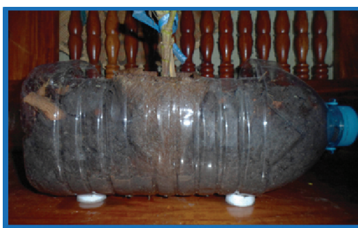
ภาพที่ 8 การทดลองเพื่อศึกษาการย่อยสลายของถุงเพาะชำต้นกล้า Mo-Bag
